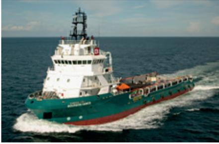
Weitere: AHT Ankerziehschlepper, AHTS Ankerziehschlepper / Materialtransporter
