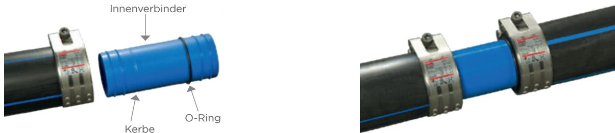
100 mm Rohr freistellen. Rohrenden leicht seitwärts biegen und den Reparatur-Verbinder bis zum O-Ring in eines der beiden Rohrenden schieben. Die Schellen bündig auf die Rohrenden schieben.
